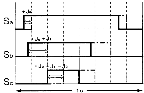
그림 4. 랜덤하게 위치한 PWM 펄스 (sector = 1) Fig 4. SRP-PWM waveform (sector = 1)
