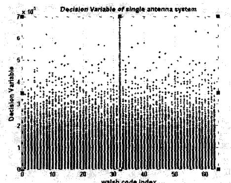
그림 7. 단일 안테나 시스템의 월쉬 복조기의 결정 변수
