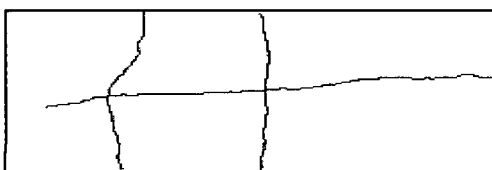
그림 13. 실내 벽면 영상에서 추출된 균열. Fig. 13. Extracted cracks of indoor wall.
