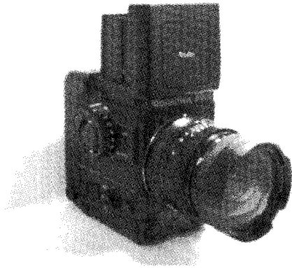
그림 2. Rollei 6006 Metric Camera
