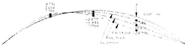
그림 25. 실험체의 하중강도별 처짐 형상(B/H=2)
