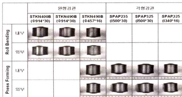
그림 7. 강관 용접부의 굽힘 실험결과
