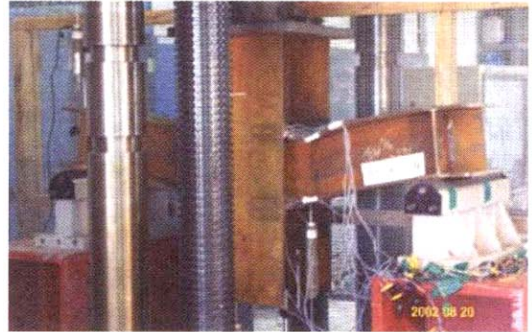
그림 9. 기존 브라켓 형식 약축접합의 휨파괴
