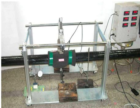
그림 4-1 PVC 파이프 시험.
