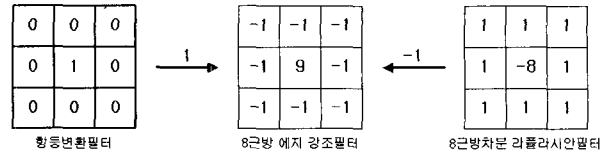
그림 4. Laplacian 차분 근사 필터 Fig. 4. Laplacian differential filter
