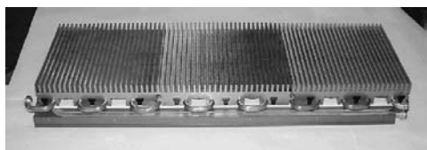
그림 9. 냉각배관과 모터코어, 단열판 조립
