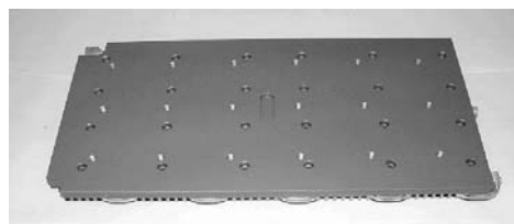
그림 11. 코어부, 배관, 단열판 조립
