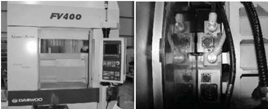
그림 12. 금형센터 그림13. 교체된 리니어모터(Y축)
