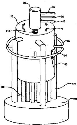
하는 공기 투입관과, 상기 공기 투입관의 일측에 구비되어 상기 공기 투입관에 외부공기를 송풍하는 링블러워와, 상기 보일러본체의 내부 소정위치에 구비되어 상기 가스 투입관 및 공기 투입관의 일단부에 구비되어 화염을 발생시키는 버너부와, 상기 버너부의 일측에 구비되어 화염이 발생가능하도록 전기에 의해 스파크를 발생시키는 전기점화장치와, 상기 전기점화장치를 제어하는 콘트롤부와, 상기 보일러 본체의 일측에 개폐가능하게 구비되며 상기 버너부 및 전기점화장치의 수리를 용이하게 하는 개폐부재로 구성되어 이루어지는 것을 특징으로 한다.
