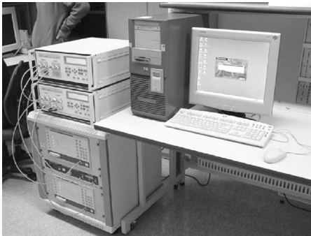
[그림 2] CDG Stage 2 시험 장비구성(RACAL Instruments 1X-AIME)
