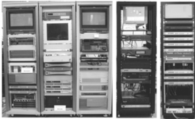
그림 2. 헤드엔드 시스템(좌로부터 하모닉, 텐드버그, SA 헤드엔드)
