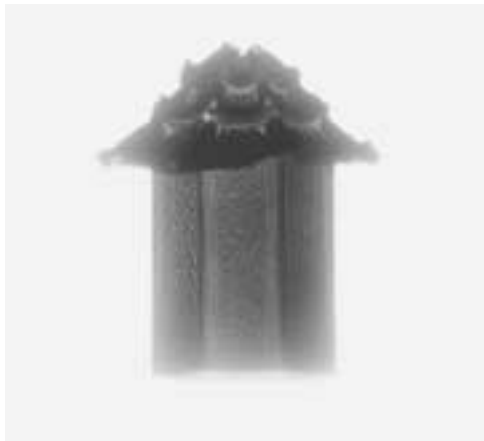
Photo 4. 탐신과 지붕의 X-ray 사진 촬영조건: 120kV, 2.5mA, 50sec)
