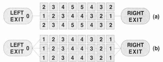
〈그림 4〉 출구와 구획과의 연결 예, (a) 한개 Arc연결, (b) 3개 Arc 연결
