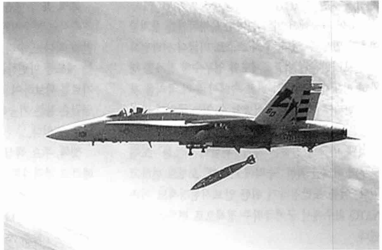
위성항법장치를 이용해 탄착정확도가 10미터 이내인 정밀유도폭탄(JDAM)
