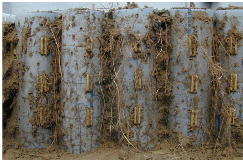
그림 4. 침수시험 및 전단강도 측정용 뿌리분 공시체
