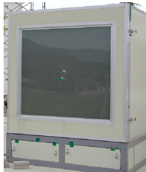
그림 1. 투명단열재를 설치한 실험모델
