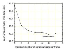
Fig. 5. Mean of packet delay time with respect to maximum number of serial numbers assigned in a frame (duplication rules: ADR-T1, W=100, L=8,  $\lambda=0.5$ ,  $\varepsilon=0.01$ ) 그림 5. 프레임 당 부여할 수 있는 최대 순차 번호 의 수에 따른 평균 패킷 지연 시간 (중복 규칙: ADR-T1, W=100, L=8,  $\lambda=0.5$ ,  $\varepsilon=0.01$ )
