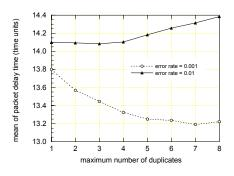
Fig. 2. Mean of packet delay time with respect to maximum number of duplicates of number а serial (duplication FDR, rule: W = 64, L = 8, $\lambda = 0.5$ ,  $\varepsilon \in \{0.01, 0.001\}$ 그림 2. 순차 번호의 최대 중복 수에 따른 평균 패킷 지 연 시간 (중복 규칙: FDR, W=64, L=8,  $\lambda=0.5$ ,  $\varepsilon \in \{0.01, 0.001\})$
