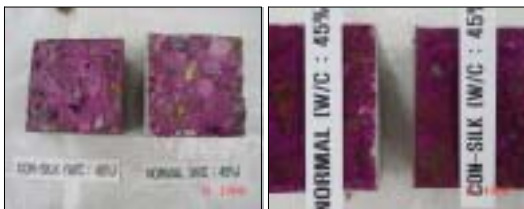
(a) 2주 중성화 시험결과(실험실) (b) 4주 중성화 시험결과(실험실)
