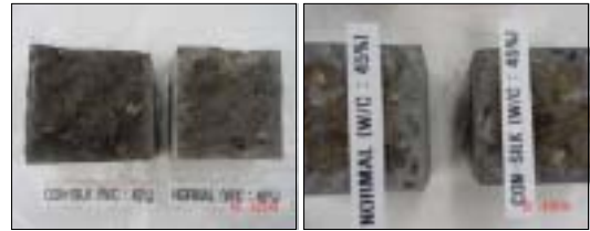
(a) 2주 염소이온침투 시험결과(실험실) (b) 4주 염소이온침투 시험결과(실험실)
