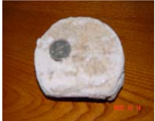
Fig. 14 뒤채움된 모르타르의 천공 후 모습
