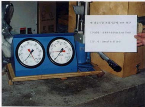
사진 4. 점재하 시험(Point Load Test) 광경
