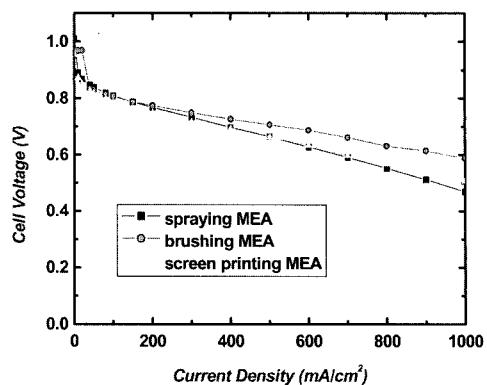
Fig. 1. 전극 촉매층 제조 도구에 따른 I-V 특성 비교.
