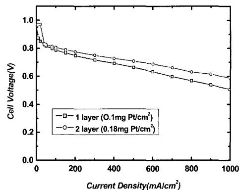
Fig. 3. 스크린 프린팅 횟수에 따른 백금 함침량과 I-V 특성.
