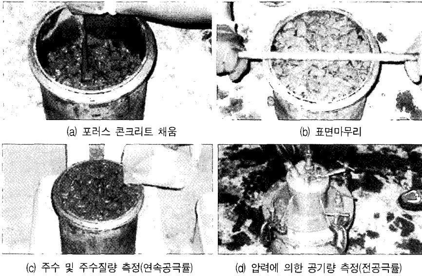
사진 8. 굳지 않은 포러스 콘크리트의 공극률 측정방법
