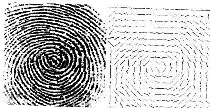
[그림 14] 지문영상의 방향성 추출 결과 [Fig. 14] Result of direction extraction in fingerprint image
