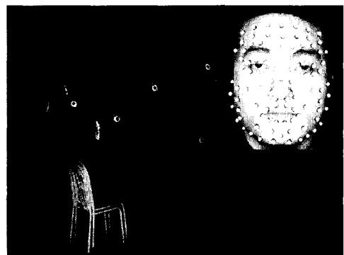
[그림 1] 액터의 얼굴에 부착한 마커 100개의 위치와 크기 및 얼굴 모션 캡처 장면
