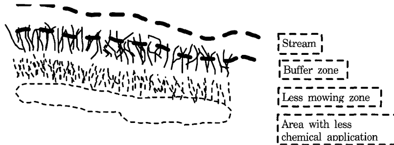
그림 6. 수계로 유입되는 화학물질(비료, 농약 등)의 저감 전략(수계: 자연성 및 자연생태계를 유지하도록 조성, buffer zone: 고유 식물을 식재하여 잘 자라도록 유지 관리, 모든 골프코스 에 도입할 필요가 있음, less mowing zone: 화학물질이 직접 수계로 유입되는 것을 방지)
