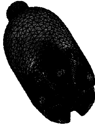
그림 17. Prediction of maximum principle stress in a PET bottle.
