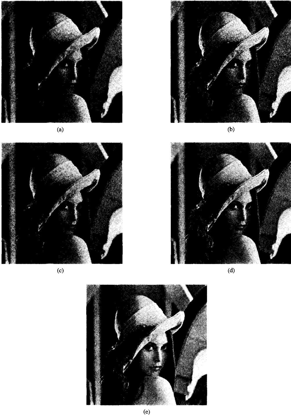
그림 7. 그림 1(b) 영상에 대한 복원 영상: (a) 호모모르픽 5 \times 5 평균 필터, (b) 5 \times 5 메디안 필터, (c) 호모모르픽 5 \times 5 방향성 MMSE 필터, (d) 호모모르픽 웨이브렛 기반 MMSE 필터, (e) 에지 영역을 고려한 호모모르픽 웨이브렛 기반 MMSE 필터
