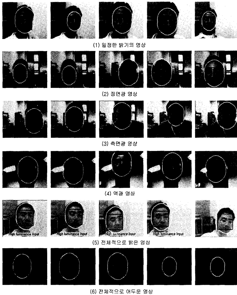
그림 6 6종류 조명 조건의 예제 영상 및 실험 결과
