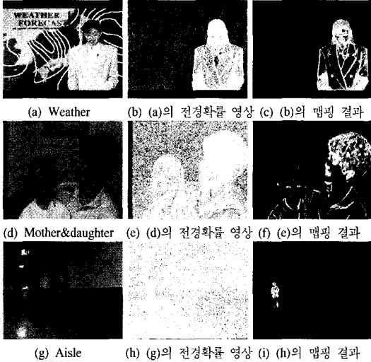
그림 8. Nonparametric 배경 모델에 의한 전경 확률 영상 및 오일러 수 기반 맵핑 결과
