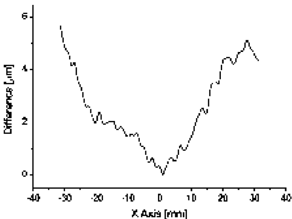
그림 9. 스타일러스와의 측정 프로파일 차이값(실리콘 웨이퍼).
