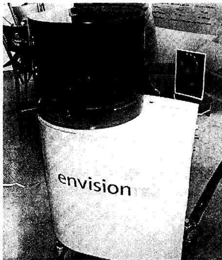
그림 1. Perfactory는 수지에 가시광선을 비추으로써 부품을 만든다. DLP 프로젝터에 의해서 층들이 밑으로부터 감광되면서, 위로부터 아래로 부품이 형성되어진다.
