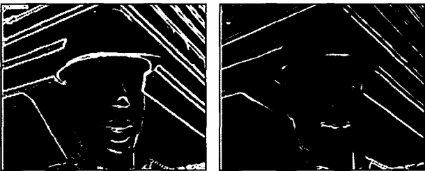
(a) 윤곽선 검출만 사용 (b) 밝기 함수 사용 후 윤곽선 검출 사용 그림 5. 공간 마스크 Fig. 5. Spatial masking (a) only using the edge detection, (b) using the edge detection after applying the brightness function.
