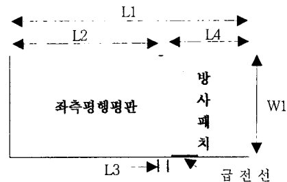
그림 3. 단순화된 chip antenna 아래면 구조 Fig. 3 Under plane of simplified chip antenna
