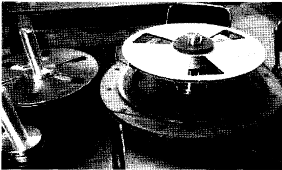
Fig 2. 권선기를 이용하여 더블 팬케익 코일을 감는 모습 Fig. 2. Winding the double pancake coil with winding machine
