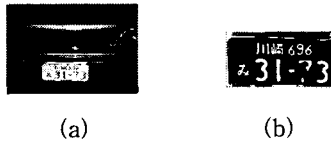
그림 12. 제안한 시스템에 일본 차량 번호판 추출 결과 영상 영상: (a) 입력 영상, (b) 추출된 번호판.
