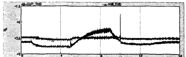
(j) 출력전류 및 출력전압의 종합왜형률(CUR_THD 및 Volt_THD) (j) THD for output current & output voltage (CUR_THD & Volt_THD)
