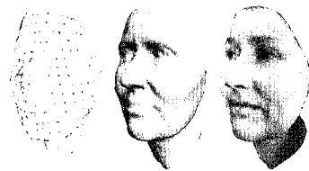
그림 4 레이저 스캐너를 이용한 3차원 데이터 생성
