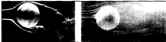
그림 7 야구공과 테니스공 주위의 유동가시화 결과 예
