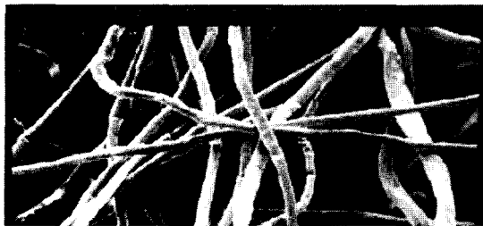
Figure 16. 라이오셀 멜트블로우부직포의 표면구조.
