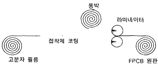
그림 1. 3층 FCCL 제조 공정.
