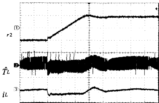
그림 4.1 MUT의 각부 파형 (1)속도(1000[rpm/Div]) (2) \hat{\tau}_L (100[Nm/div]) (3) 추정된 부하토크 전류 i_L Time/div 2[Sec]
