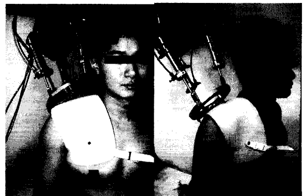
그림 10. 환자와 로봇시스템의 연결기구 Fig. 10. Human and robot system link harness
