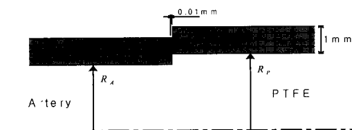
그림 2. 초기 end-to-end 문합의 축대칭 모델 치수 Fig. 2. Dimension of axisymmetric model of initial end-to-end anastomosis
