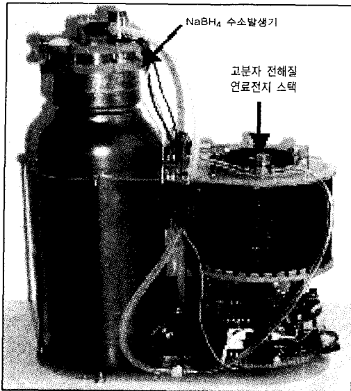
그림 8 NaBH 4 수소발생기로 가동되는 50W급 PEMFC
