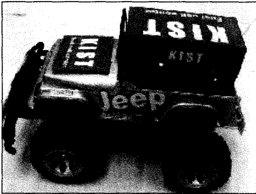
그림 10 KIST에서 제작한 2.5W급 DMFC로 구동되는 모형차
