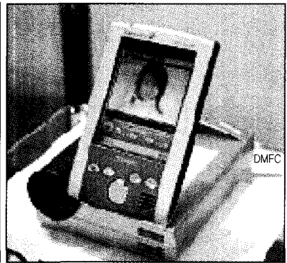
그림 5 NEC에서 개발한 DMFC로 가동되는 PDA
