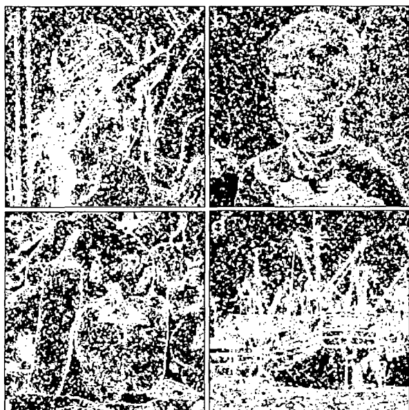
그림 2 기존의 Wiener 필터에 의해서 평탄 영역과 에지 영역으로 분류된 시험 영상들: (a) Lena, (b) Girl, (c) Pepper, (d) Boat Fig. 2 Test images classified in plain region and edge region by the conventional Wiener filter : (a) Lena, (b) Girl, (c) Pepper, (d) Boat
