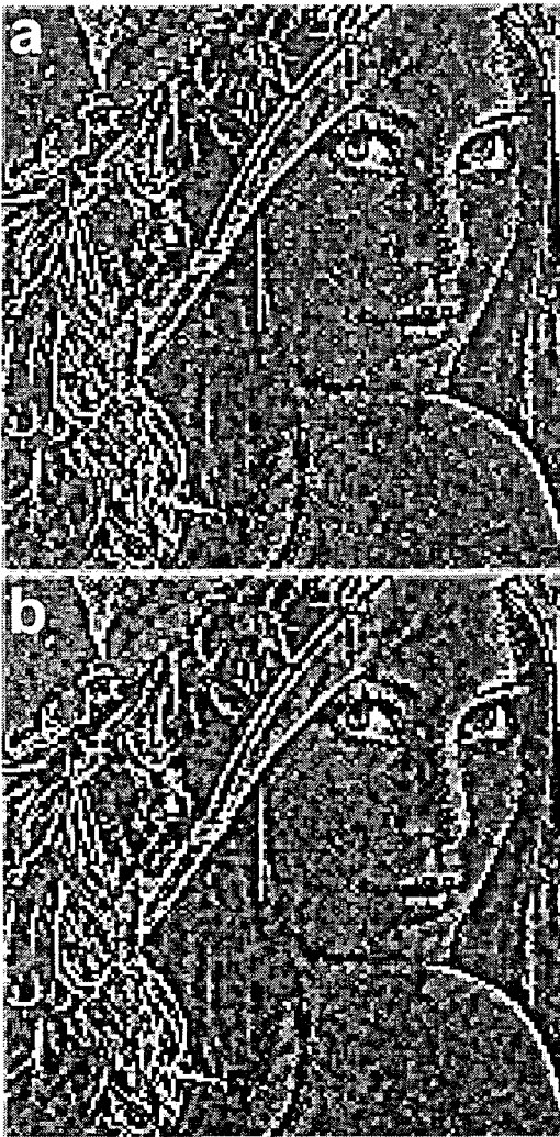
그림 9 필터링된 영상들에 고주파 필터를 적용한 결과 영상들: (a) 기존의 Wiener filter, (b) PM1
