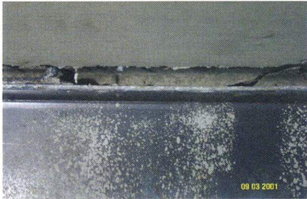
그림 12. TS812C-R20S20 실험체의 수평전단파괴 성상
