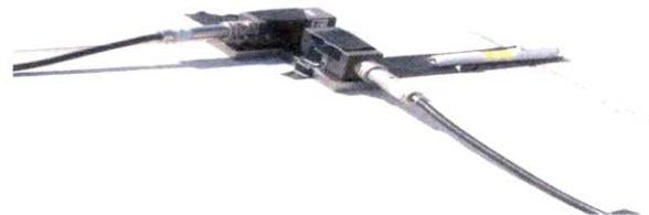
(a) 서보가속도계 센서 설치 상황
