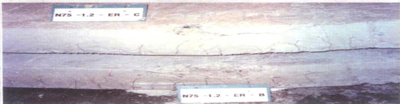
그림 9. 파괴된 시험체의 균열 모습
